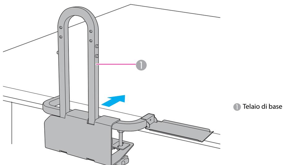
(3) Allineare un lato dell'arco a U del telaio di base ( ① nella seguente figura) alla linea mediana dello schermo di proiezione ( ② nella seguente figura), in modo da allineare il centro dell'obiettivo al centro dello schermo.
