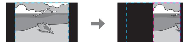
**Schermo intero:** regola in base alle dimensioni del pannello del proiettore (l'area massima di visualizzazione di un'immagine).
