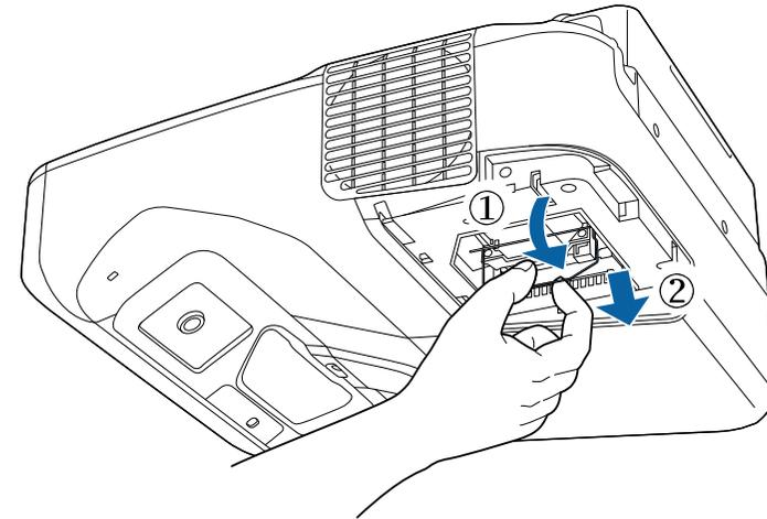
**5** Lösen Sie die Schrauben, die die Lampe am Projektor befestigen. Die Schrauben kommen nicht vollständig heraus.
