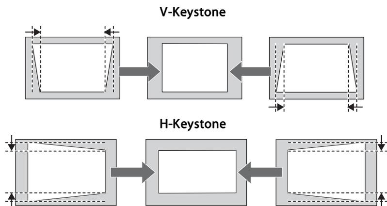
Si le format d'image est incorrect, réglez l'équilibre en utilisant **Balance V** et **Balance H**.
