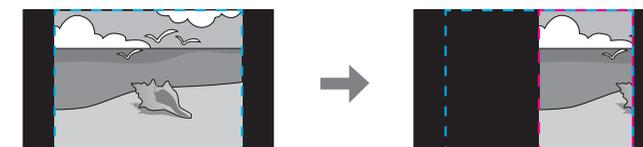
**Aff. plein écran** : permet de procéder à des réglages en fonction de la taille de l'écran du projecteur (zone maximale dans laquelle une image peut être affichée).
