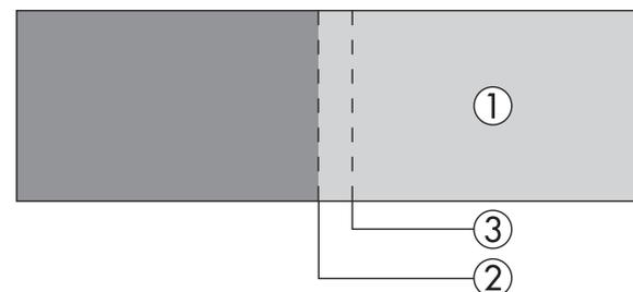
Dans l'exemple ci-dessus, vous devez ajuster le **Bord gauche** car vous pouvez voir des zones superposées sur le côté gauche de l'image (1).
