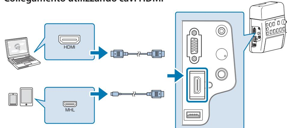
Se si utilizza un cavo HDMI spesso può scollegarsi a causa del suo peso. Utilizzare il morsetto del cavo HDMI per fissarlo.
