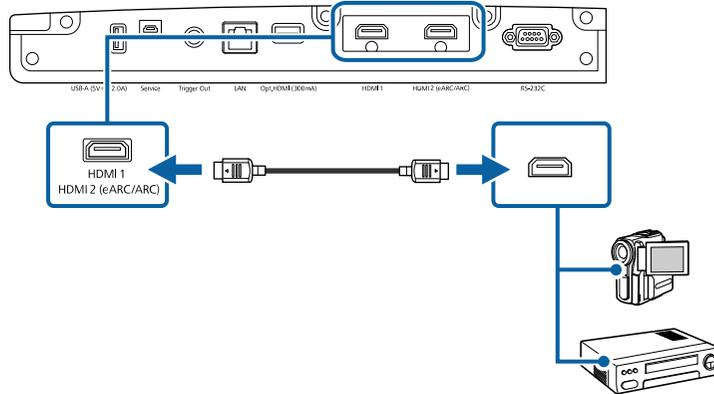
Stromanschluss des Kabels mit dem Anschluss Opt.HDMI (300mA) verbinden.
