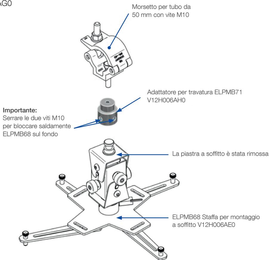
ELPMB68 Staffa per montaggio a soffitto V12H006AE0 e morsetto per tubo da 50 mm venduti separatamente.
