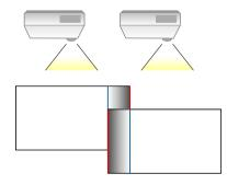
• Sélectionnez le paramètre **Courbe superposition** et sélectionnez un gradient pour la zone ombrée sur les projecteurs.
