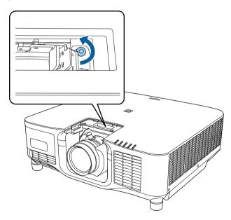
Tenez fermement l'objectif en pinçant le levier de verrouillage et déplacez-le vers la position **Release**.
