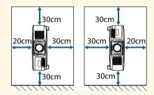
• N'installez pas le projecteur dans un endroit qui ne permet pas à l'air de circuler, par exemple sur une étagère ou dans une boîte.
