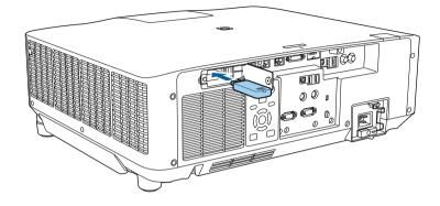
Remettez en place le capot du module réseau local sans fil comme indiqué et serrez les vis.
