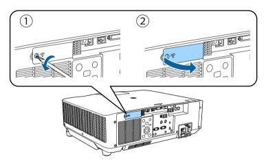
Connectez le module LAN sans fil à l'emplacement du module LAN sans fil.
