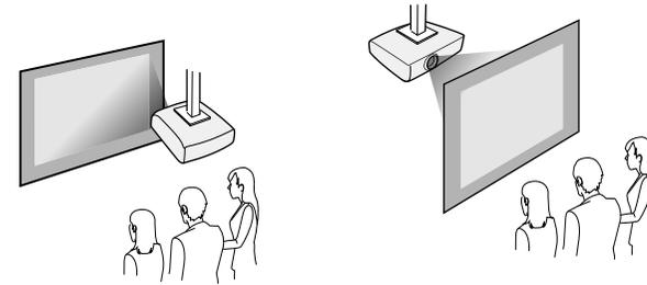
Wählen Sie die entsprechend der verwendeten Installationsmethode richtige **Projektion**-Option im Projektormenü **Installation**. Bei Bedarf schalten Sie **Taste Richtgsumkehr** im Projektormenü **Betrieb** ein und passen **Menüdrehung** im Projektormenü **Display** an.
