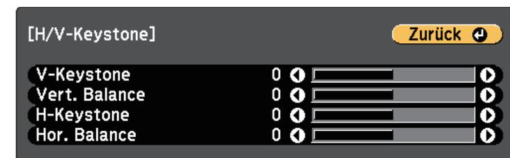
**6** Mit den Pfeiltasten am Projektor oder an der Fernbedienung können Sie zwischen vertikaler und horizontaler Trapezkorrektur wählen und die Bildform wie erforderlich anpassen.
