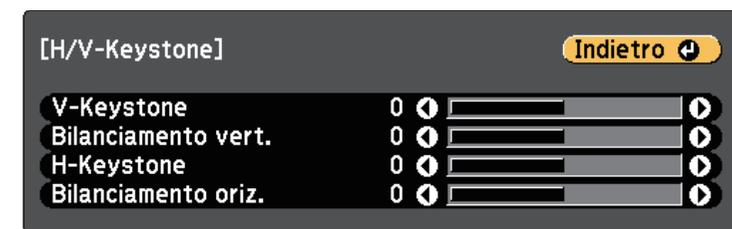
**6** Utilizzare i tasti freccia del proiettore o il telecomando per selezionare correzione keystone verticale e orizzontale e per regolare la forma dell'immagine se necessario.
