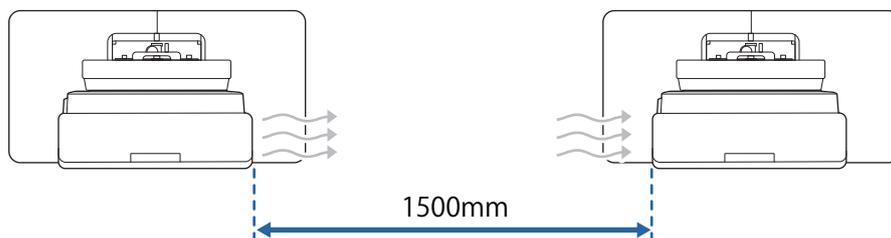
Se non è possibile lasciare uno spazio di circa 1.200 mm, installare una partizione per bloccare il calore proveniente dall'apertura di ventilazione per l'aria del proiettore.
