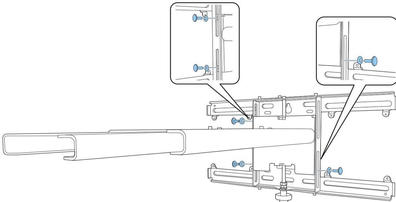
**6** Ruotare la parte inferiore dell'asse esagonale con una chiave a cricchetto da 17 mm per allineare i segni sulla piastra a parete e sulla piastra di installazione
