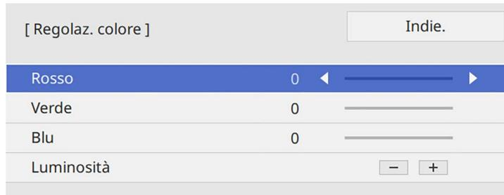
È possibile utilizzare i tasti **Luminosità** per regolare i valori RGB simultaneamente.
