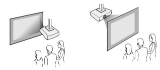
Sélectionnez la bonne option de **Projection** dans le menu **Installation** du projecteur en fonction de la méthode d'installation utilisée. Ajustez si nécessaire le paramètre **Rotation du menu** dans le menu **Affichage** du projecteur.
