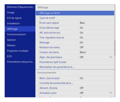
Sélectionnez Align. des panneaux et réglez-le sur On.
