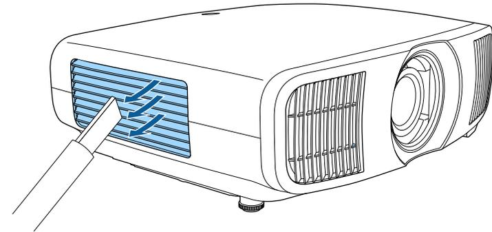
**3** Desserrez les vis et retirez le capot du filtre à air.
