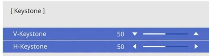
**6** Utilizzare i tasti freccia del proiettore o il telecomando per selezionare correzione keystone verticale e orizzontale e per regolare la forma dell'immagine se necessario.
